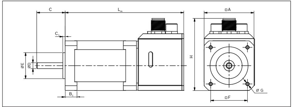
Abbildung zeigt Schrittmotor ISS0420073
