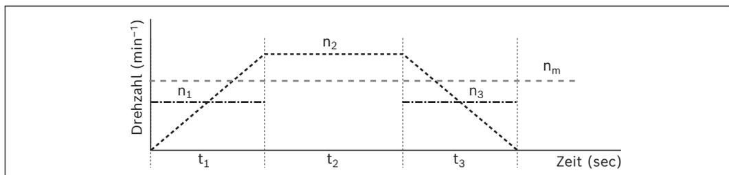
Drehzahl in Beschleunigungs- und Bremsphasen  $n_{1 \dots n}$ :
