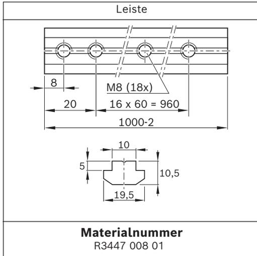
Zur Befestigung von Aufbauten auf der Verbindungsplatte.
