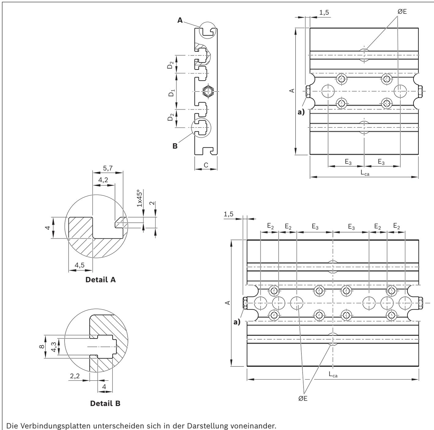
a) Trichterschmiernippel DIN 3405-D4; 2-seitige Schmiermöglichkeit (Zentralschmierung nur mit Fettpresse über eine der zwei Seiten notwendig).
