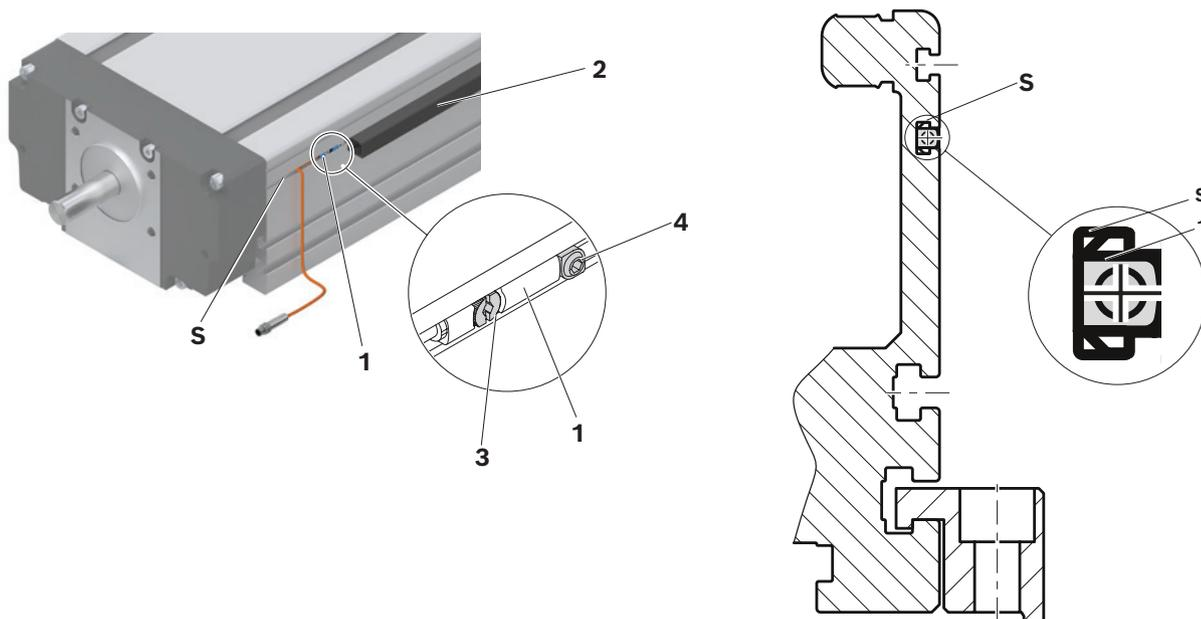
**i** Beim CKR-280-DB (Compactmodul CKR mit 2 Motoranbauten) muss auf jeder Seite des Hauptkörpers ein Schaltsystem (Sensor/Kabelkanal) für jeden Antrieb/Tischteil montiert werden.
