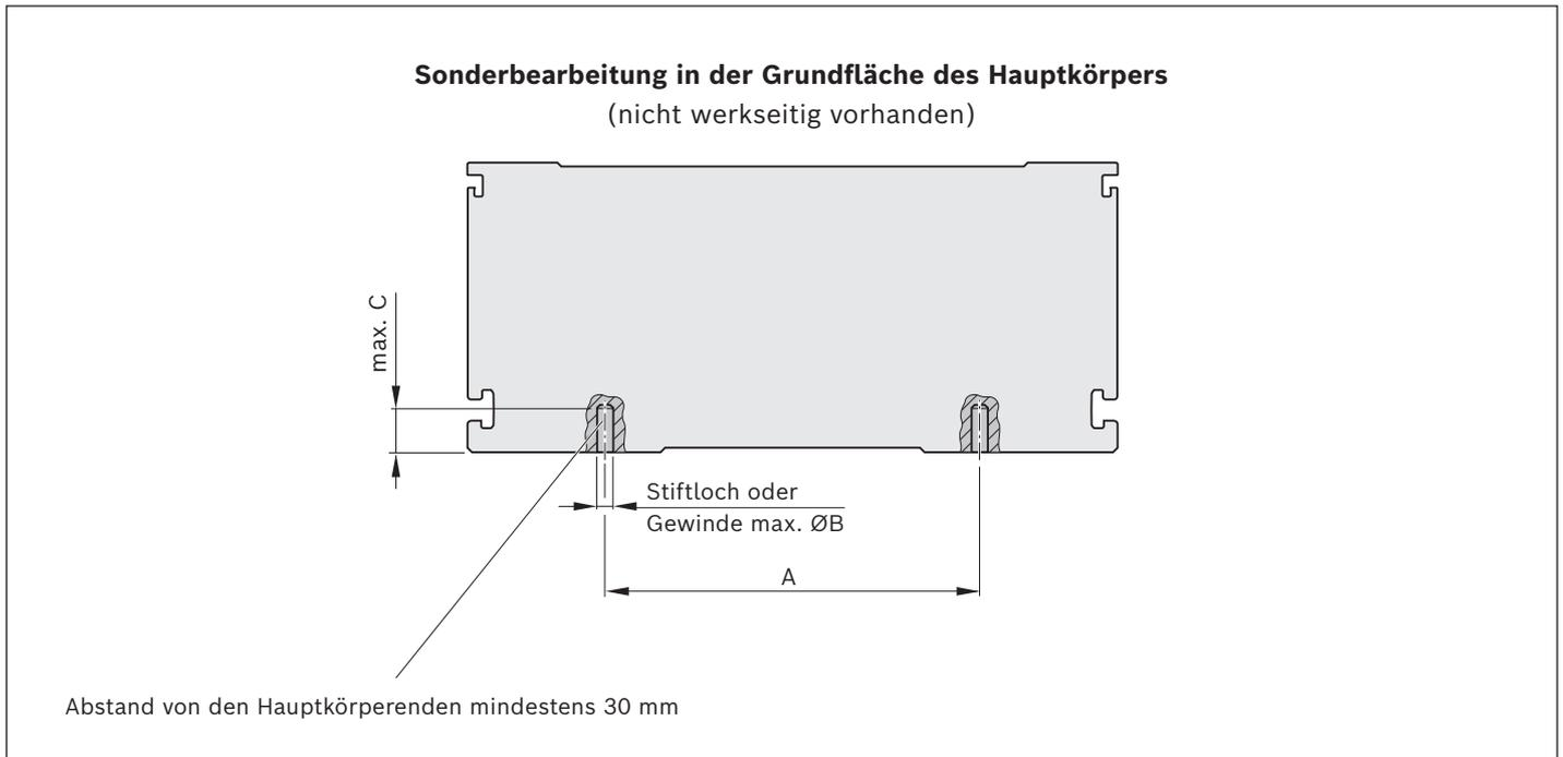
Mögliche Befestigung durch Sonderbearbeitung in der Grundfläche des Hauptkörpers
