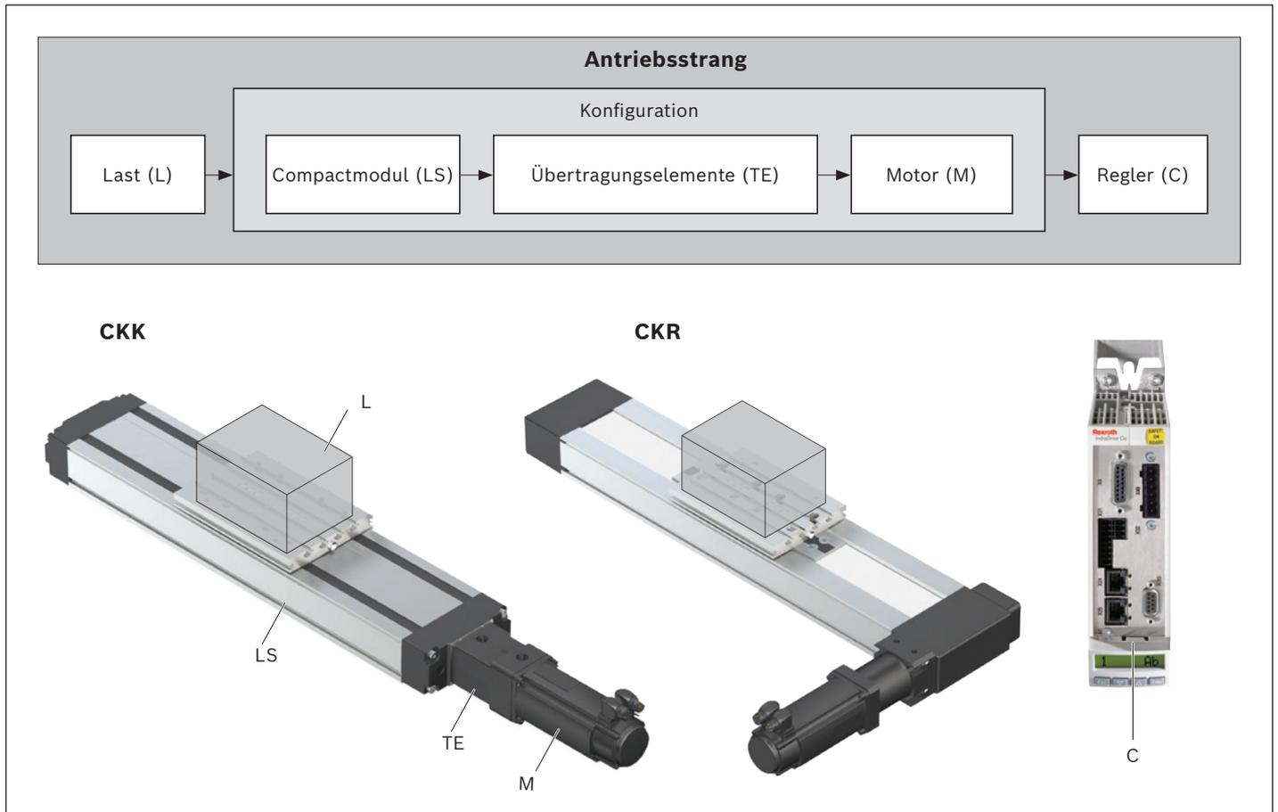
Die korrekte Dimensionierung und Beurteilung einer Anwendung erfordert die strukturierte Betrachtung des gesamten Antriebsstrangs.
